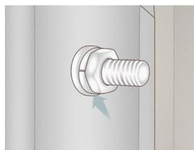
4. Lông đên đã được siết chặt vào bề mặt chi tiết
