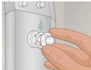
1. Đặt lông đên giữa bề mặt chi tiết và đai ốc/bulông
